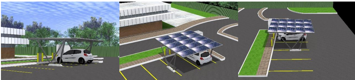
Figura 1. Vistas 3D del diseño del sistema de carga de vehículos eléctricos con energía solar.
